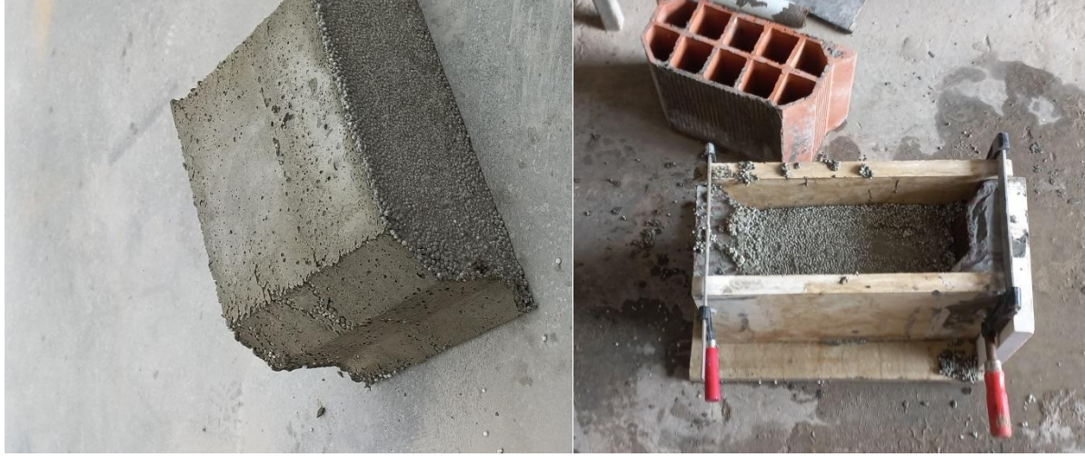
الشكل: (10) صناعة نموذج الياجور من خرسانة البولسترين
