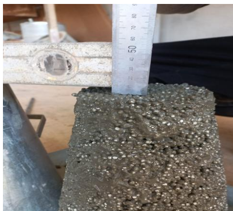
شكل: (8) اختبار الهبوط لخرسانة البولسترين.
