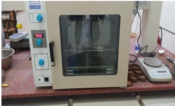
الشكل: (7) فرن التجفيف المستخدم معمل كلية العلوم التقنية بن وليد
